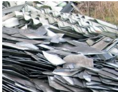
Affald fra eternitplader oplagret i strid med reglerne. Eternitplader skal tages hele ned og må ikke beskadiges, da de afgiver farlige asbestfibre. Beskadede plader skal være forsvarligt emballerede i støvtæt emballage.
